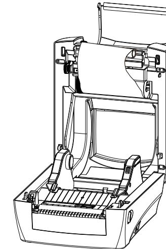
**Loading the ribbon, 安裝碳帶, 安装碳带**
