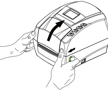
**Loading the ribbon, 安裝碳帶, 安装碳带**
