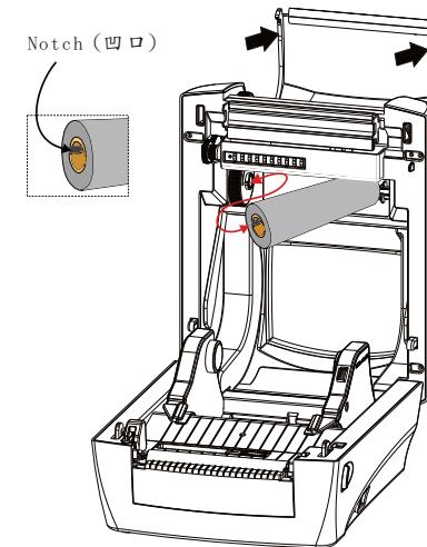
**Loading the ribbon, 安裝碳帶, 安装碳带**
